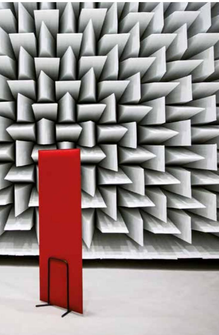
I La tecnologia Snowsound è stata testata nella camera semianecoica dell'Università di Ferrara per misurarne l'abbattimento acustico in accordo con la norma ISO 10053. Le misurazioni, effettuate con diverse configurazioni, hanno evidenziato le notevoli capacità di attenuazione acustica di Snowsound, registrando le performance alle diverse frequenze.
