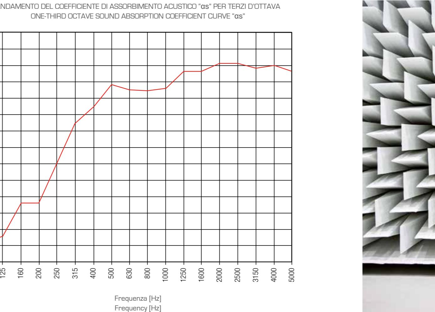
I Misura dell'assorbimento acustico in camera riverberante UNI EN ISO 354 [pannelli Mitesco/Snowsound® installati accostati e con intercapedine d'aria posteriore di 200 mm].
