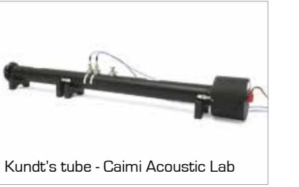
**I** Il tubo di Kundt [UNI EN ISO 10534-2] permette di rilevare valori compresi tra 0 e 1 ovvero tra 0% e 100%, non confrontabili con i valori rilevati in camera riverberante [UNI EN ISO 354] che possono anche essere superiori a 1.
